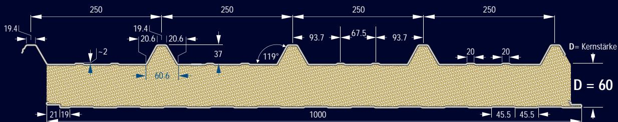
Außenschale:  **$t_N = 0,60 \text{ mm}$**   $R_{p0,2} \geq 280 \text{ N/mm}^2$
